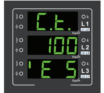
Şekil 4. "Akım Trafo Değeri"ni gösteren ekrandır.
