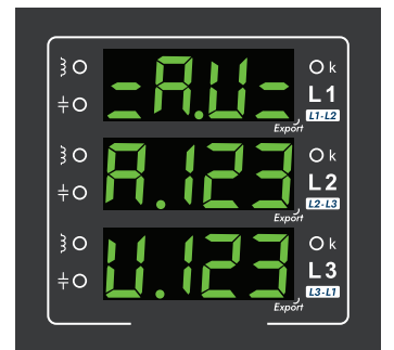
Şekil 6. Kurulum esnasında eşleşen "Gerilim-Akım Çiftleri"ni gösteren ekran görüntüsü
