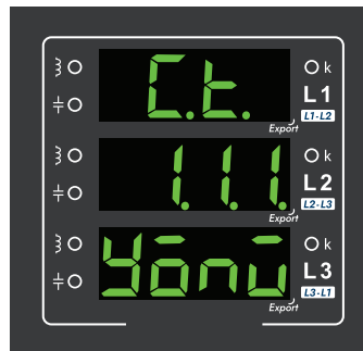
Şekil 5. Kurulum esnasında cihazın tespit ettiği "Akım Trafo Sekonder Yönleri"nin ekran görüntüsü
