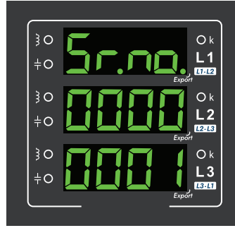
Şekil 1. Cihazın "Seri Numarası"nı gösteren ilk açılış ekranı
