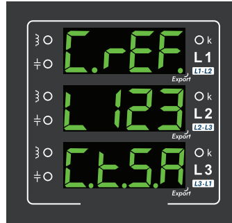
Şekil 3. "Akım Referansı"nı gösteren ekrandır.
