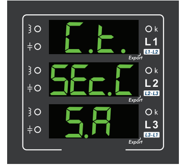
Şekil 2. Akım trafosunun "Sekonder Akım Değeri"nin ayarlandığı ekrandır. (1A veya 5A olarak ayarlanabilmektedir.)
