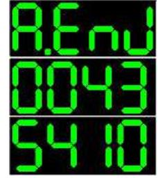
Şekil 2.1 Toplam aktif enerjinin cihaz ekranındaki görüntüsü
