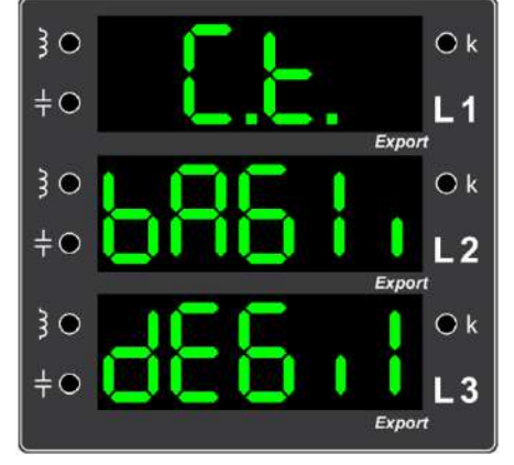
Örnek Hata 15. Akım trafosunun bağlı olmadığını gösteren ekran görüntüsü (Lütfen akım trafosunu bağlayınız.)
