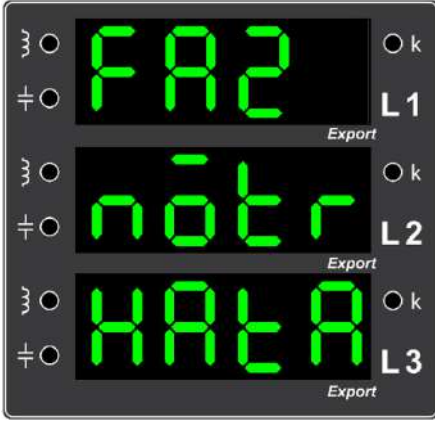
Örnek Hata 13. Faz/Nötr bağlantı hatasını gösteren ekran görüntüsü (Faz girişlerini ve nötr bağlantısını kontrol ediniz.)
