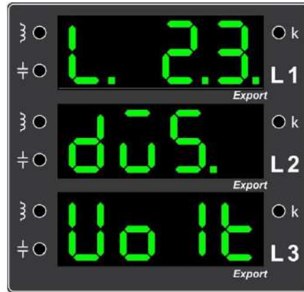
Örnek Hata 8. İkinci ve üçüncü fazların gerilimlerinin düşük olduğunu gösteren ekran görüntüsü (İkinci ve üçüncü fazların gerilimlerini kontrol ediniz.)
