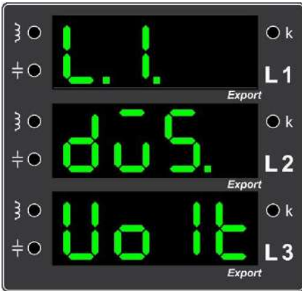
Örnek Hata 7. Birinci fazın geriliminin düşük olduğunu gösteren ekran görüntüsü (Birinci fazın gerilimini kontrol ediniz.)
