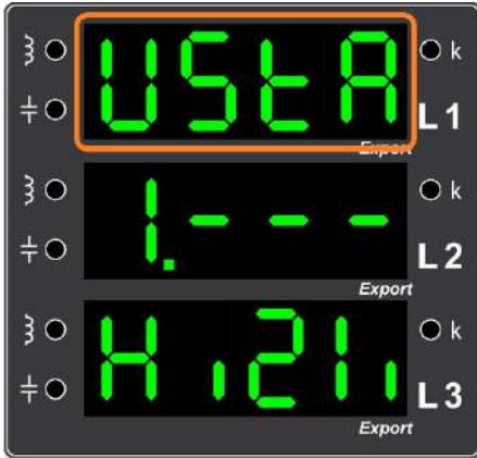
Şekil 2.2. Menüye girildiğinde birinci satırda görülen “Usta” erişim seviyesi
