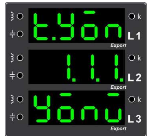
Şekil 4. Kurulum esnasında cihazın tespit ettiği "Akım Trafo Sekonder Yönleri'nin ekran görüntüsü
