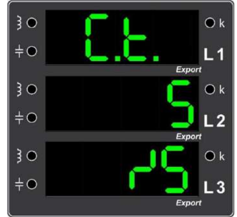
Şekil 2. Akım trafo değeri (Current Transformer Value) X/5 formatında gösteren ekran görüntüsü
