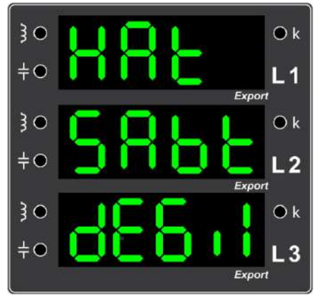
Örnek Hata 24. Kademe çekme/bırakma limitini aştığını ifade eden ekran görüntüsü (Bağlantıları kontrol ediniz ve daha stabil akımda işleminizi tekrarlayınız.)
