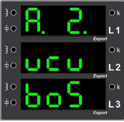
Örnek Hata 10. İkinci fazın akım girişinin boş olduğunu gösteren ekran görüntüsü (İkinci fazın akım bağlantısını kontrol ediniz.)
