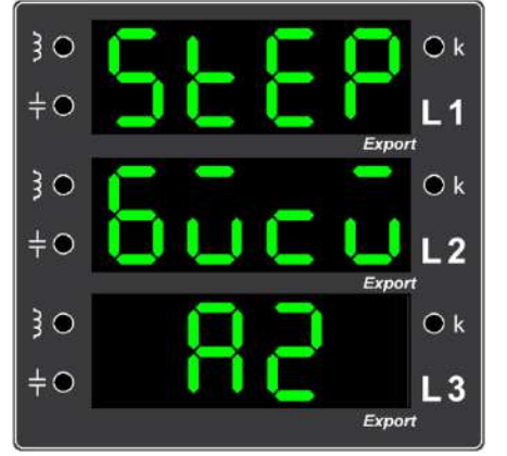
Örnek Hata 18. Kurulumun mevcut kademelerle tamamlanamadığını ifade eden ekran görüntüsü (Bağlantıları ve kademeleri kontrol edip, kurulumu tekrarlayınız.)
