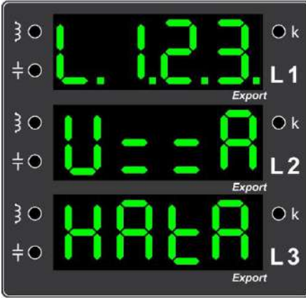
Örnek Hata 23. Otomatik akım-gerilim eşleşmesi kapalı olduğu durumlarda; tüm fazların gerilim-akım uçlarının eşleşmemiş olduğunu gösteren ekran görüntüsü (Tüm fazların gerilim ve akım uçlarının doğru sırada bağlandığından emin olunuz.)
