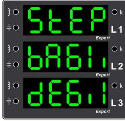
Örnek Hata 14. Kademe bağlantı hatasını gösteren ekran görüntüsü (Kademe bağlantılarını kontrol ediniz.)
