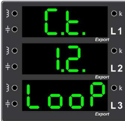
Örnek Hata 16. Birinci ve ikinci fazların akım trafo uçları kendi aralarında çevrim (loop) oluşturacak şekilde karıştırılarak bağlandığını gösteren ekran görüntüsü (Birinci ve ikinci fazların akım trafolarının uçlarını kontrol ediniz.)
