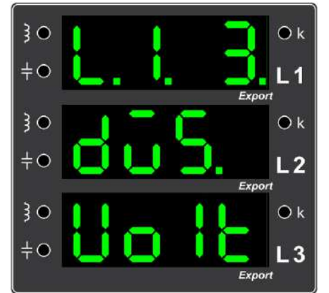
Örnek Hata 9. Birinci ve üçüncü fazların gerilimlerinin düşük olduğunu gösteren ekran görüntüsü (Birinci ve üçüncü fazların gerilimlerini kontrol ediniz.)
