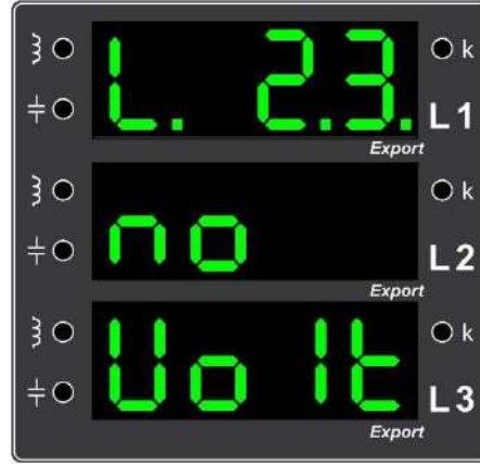
Örnek Hata 5. İkinci ve üçüncü fazların gerilim girişlerinin boş olduğunu gösteren ekran görüntüsü (İkinci ve üçüncü fazların gerilim bağlantılarını kontrol ediniz.)
