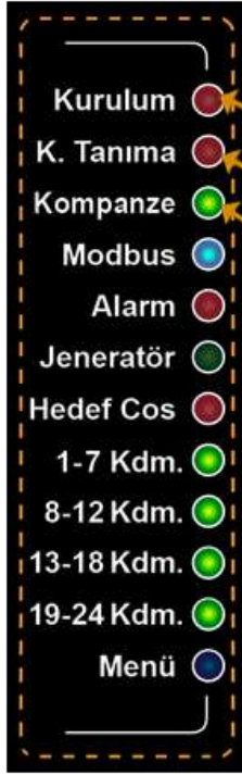
Şekil 5. Cihazın üst kısmında kademelerin durumlarını gösteren Kademe LED’leri Şekil 6. Cihazın sol kısmında bulunan Durum LED’lerinden “K.Tanıma” LED’i kademe tanıma esnasında sürekli yanar.
