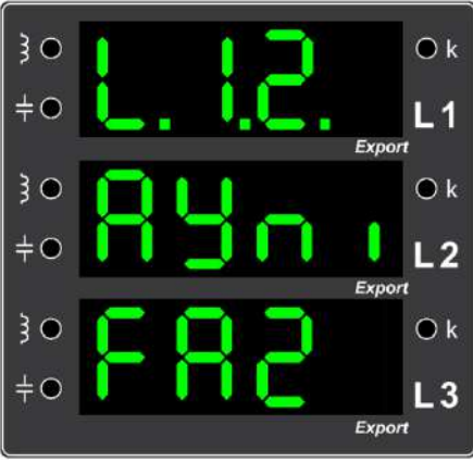
Örnek Hata 19. Birinci ve ikinci fazlar için bağlanan gerilimlerin aynı fazda olduğunu gösteren ekran görüntüsü (Birinci ve ikinci fazlara doğru gerilim bağlantısını yapınız.)
