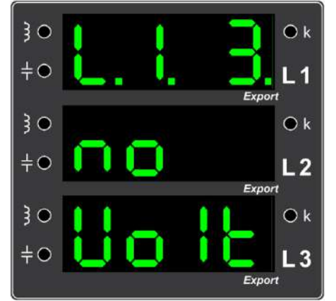
Örnek Hata 6. Birinci ve üçüncü fazların gerilim girişlerinin boş olduğunu gösteren ekran görüntüsü (Birinci ve üçüncü fazların gerilim bağlantılarını kontrol ediniz.)
