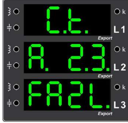
Örnek Hata 2. İkinci ve üçüncü fazların akımlarının yüksek olduğunu gösteren ekran görüntüsü (İkinci ve üçüncü fazların akım girişlerini ve akım trafo değerini kontrol ediniz.)
