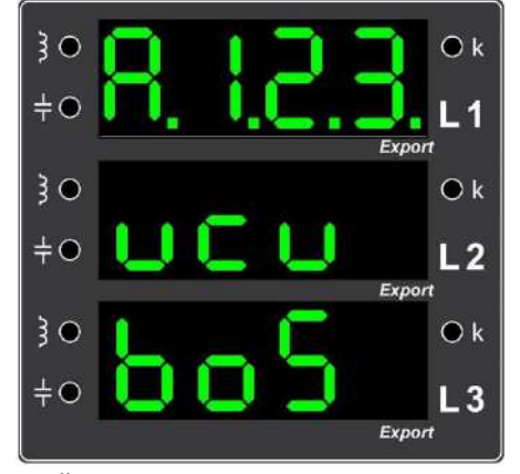
Örnek Hata 12. Tüm fazların akım girişlerinin boş olduğunu gösteren ekran görüntüsü (Tüm fazların akım bağlantılarını kontrol ediniz.)
