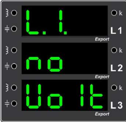
Örnek Hata 4. Birinci fazın gerilim girişinin boş olduğunu gösteren ekran görüntüsü (Birinci fazın gerilim bağlantısını kontrol ediniz.)
