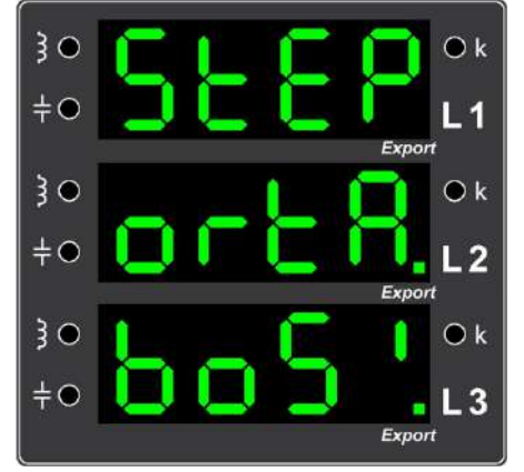
Örnek Hata 21. Tüm kademe ortaklarının boş olduğunu gösteren ekran görüntüsü (Kullanılacak kademelerin ortaklarını kontrol ediniz.)
